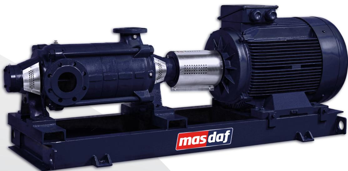
**Всасывающий фланец** DN 50 .... DN 150**Фланец со стороны выхода** DN 32 .... DN 125 ....**Рабочее давление** 40 атм.**Диапазон оборотов** 1500 - 3600 об/мин**Диапазон напора** 5 - 180 м<sup>3</sup>/ч**Диапазон макс. высоты водного столба** 30 - 400 м
